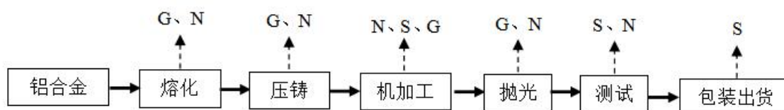
图 3-2 灯饰外壳、散热器外壳生产工艺及产污环节图
